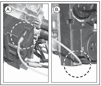
Fig. 5-2a/b Piezo igniter wiring
