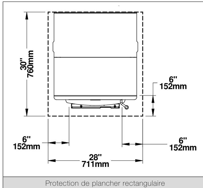
La protection de plancher doit avoir un minimum de 6" (152 mm) à l'avant de l'ouverture de porte et un minimum de 6" (152 mm) de chaque côté de l'ouverture de porte.
