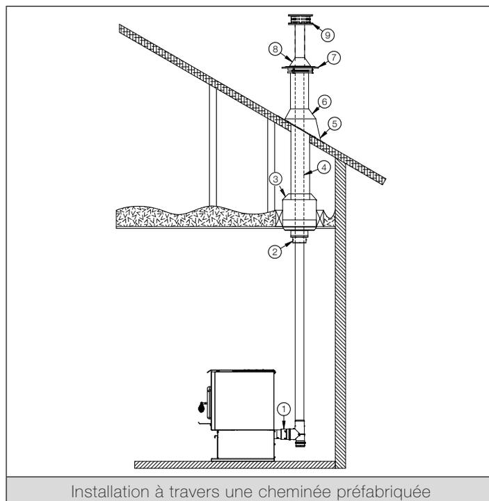
1. Retirer tout conduit de cheminée existant reliant l'appareil de chauffage à l'adaptateur universel déjà installé dans le support de plafond.
