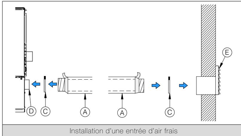
3. De l'extérieur, placer le registre d'air extérieur **(E)** dans le trou (la face ouverte vers le bas) et fixer le registre au mur à l'aide de vis.
