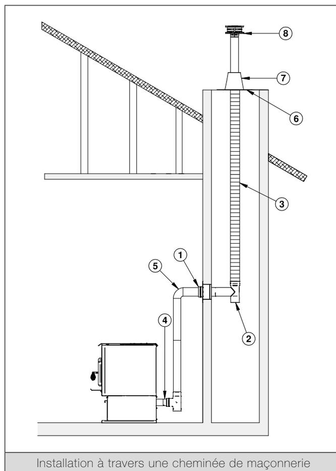
1. Positionner le poêle en respectant les dégagements du fabricant de l'appareil et du système d'évent.
