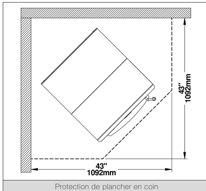
*Note: Au Canada, les dimensions de la protection de plancher présentées sur les images précédentes peuvent être utilisées SEULEMENT si l'ouverture de la porte de l'appareil ou le retrait du tiroir à cendres se fait lorsque l'appareil est complètement éteint, c'est-à-dire qu'il n'y a plus de feu dans le pot de combustion et que les ventilateurs sont éteints. Dans tous les autres cas, voir la norme CSA B365.*
