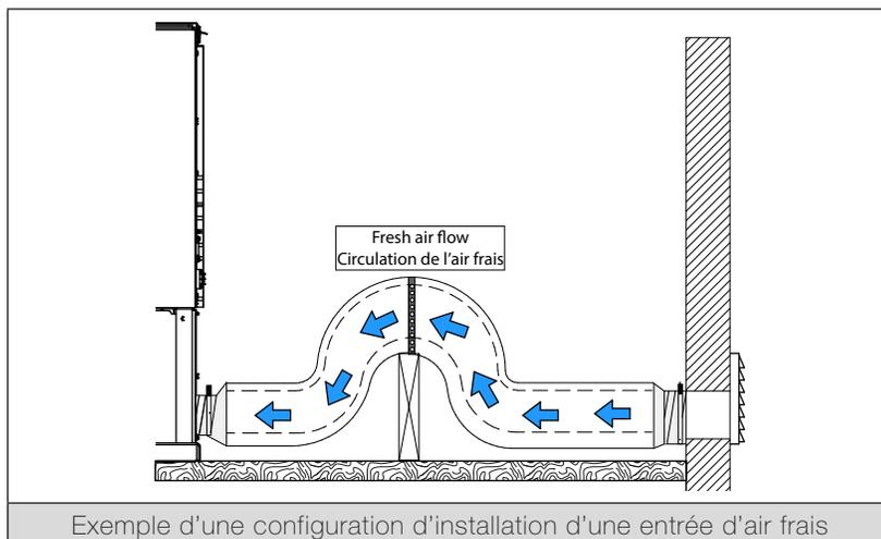
1. Installer un conduit isolé de 3" de diamètre intérieur, souple ou rigide, de type HVAC (doit être conforme aux normes ULC S110 ou UL 181, classe 0 ou classe 1) sur l'adaptateur d'air frais **(D)**. Pour ce faire, retirer délicatement l'isolant et l'enveloppe de plastique, pour exposer le tuyau flexible. Fixer le tuyau flexible au registre à l'aide de collets de serrage ou de ruban métallique **(C)**.
