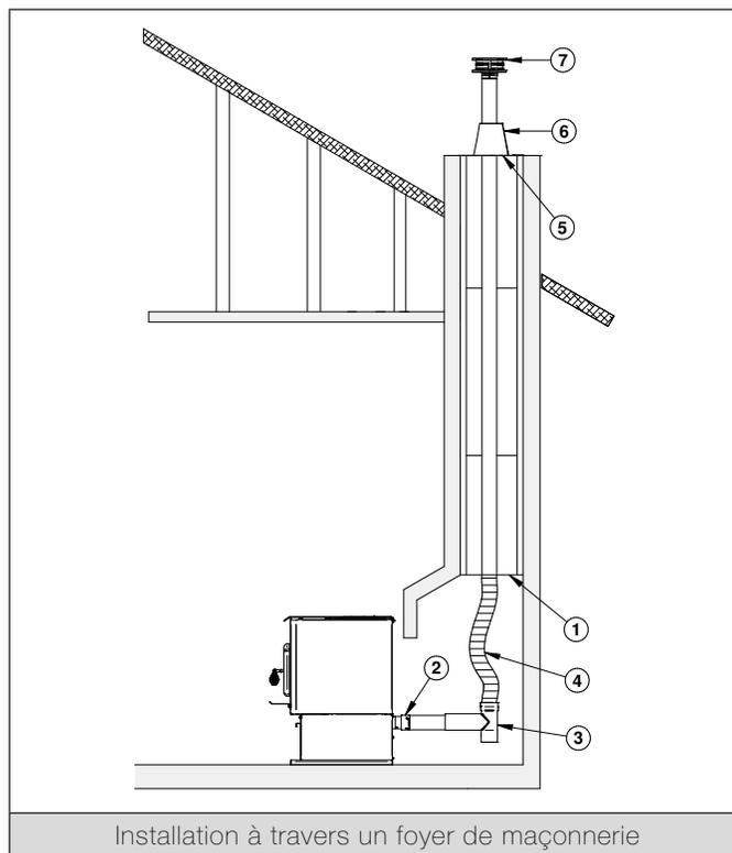
1. Fabriquer et installer une plaque d'étanchéité **(1)** à l'intérieur de la cheminée pour sceller le registre du foyer. L'utilisation d'une plaque et des vis en acier inoxydable est recommandée. Faire un trou pour le tuyau d'évent dans la plaque. Si nécessaire, faire un deuxième trou pour le tuyau d'entrée d'air frais.
