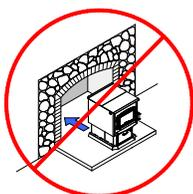
**Ce poêle n'est pas approuvé pour être installé dans l'âtre de maçonnerie. .**
