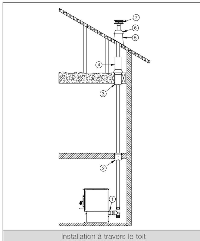
1. Positionner le poêle en suivant les dégagements du fabricant de l'appareil et du système d'évent.
