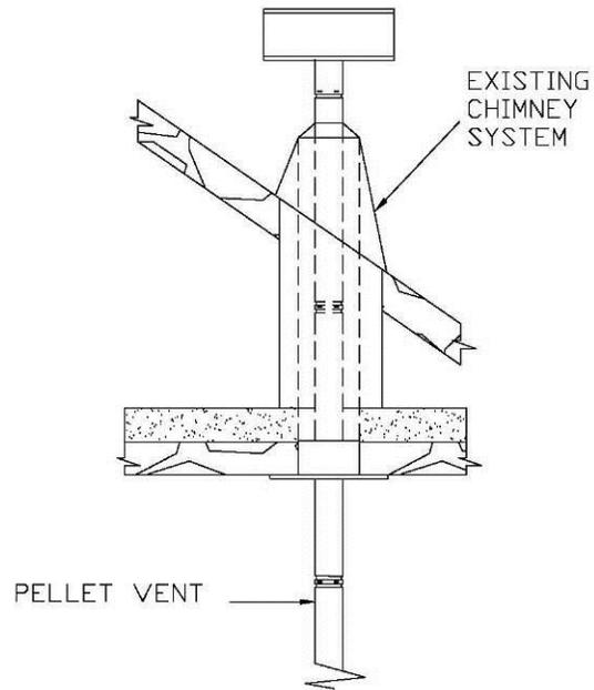
**WARNING: IN THE U.S., THE USE OF A STAINLESS STEEL LINER IS MANDATORY. IN CANADA, IT IS NOT MANDATORY BUT IS STRONGLY RECOMMENDED.**
